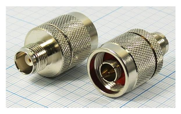
Переходник предназначен для стыковки кабелей и приборов, имеющих различные стандарты ВЧ разъемов (TNC и N-типа). Переходник имеет позолоченный центральный проводник и хромированный корпус.
